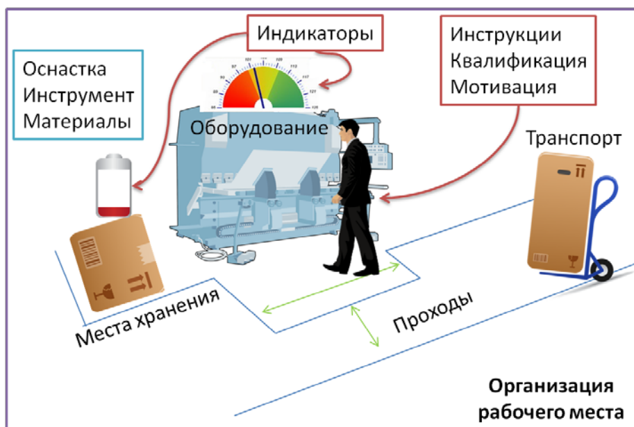
Рисунок 1 – Принципиальная схема реализации методов оптимизации производства на уровне рабочего места (рабочего центра)
